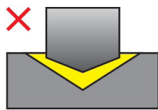
鑽頭先端角 > 倒角角度 Drill Point Angle > Centering Angle
